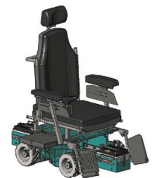
Die Batterien lassen sich ohne Demontage des Fahrwerks auswechseln und auch die Steuerung ist zugänglich. Mittels Teleskopschienen lassen sich die Aufnahmeboxen der genannten Komponenten ausfahren.
