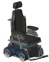
Der OmniChair in voller Ausstattung. Der Antrieb ist insgesamt 600 W stark, vier Antriebe zu je 150 W Leistung. Die Räder lassen sich durch einen einfachen Handgriff entkoppeln, so dass der OmniChair auch von Hand geschoben werden kann.
