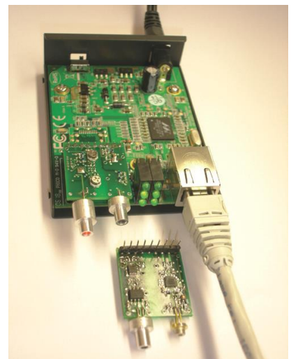
Das Foto zeigt den Gigabit-Medienkonverter in Kombination mit dem entwickelten POF-Transceiver, welcher links neben der LED-Anzeige auf dem Ethernet-Controller Print steckt. Unterhalb ist die Rückseite des Transceivers mit seinen Kernelementen ersichtlich. Dieser ist für die elektro-optische Konversion verantwortlich und ist in einen Sendepfad mit Laserdiodenansteuerung (rechts) und einen Empfangspfad mit Photodiode mit Verstärkerstufe (links) unterteilt.
