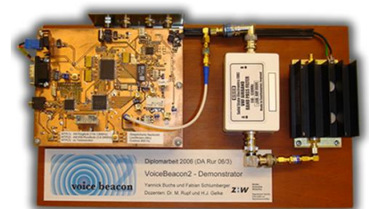
Demonstrator: kompletter Brettaufbau mit Mainboard VB2, Speisung, Flugfunk-Filter und HF-Verstärker
