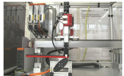
Pragevorgang einer Ellipse auf dem 3-Achs-Modell
