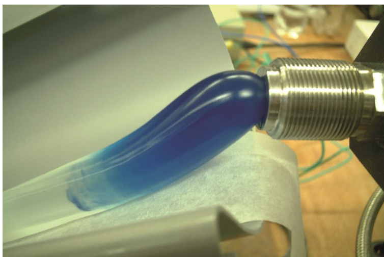
Eingefarbtetes Polymerextrudat nach dem statischen Mischer
