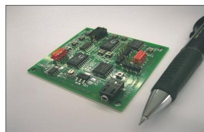
Neuer Prototyp einer einzelnen Sektion der mit SMD-Komponenten realisierten Schaltung. Die Dimensionen betragen nun ca. 60x60 mm.
