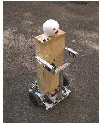
Der Einachstransporter ist nun ein vollständig autonomes System. Die Regelung erfolgt über einen digitalen Signal-Prozessor, der auf dem Fahrzeug montiert ist.
